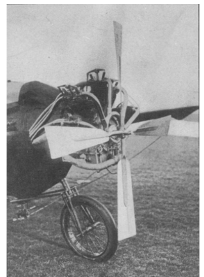
Moteur R.E.P. (Esnault-Pelterie) de 60 CV (1908), 7 cylindres en éventail, monté sur un monoplane R.E.P.
